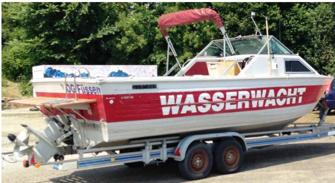
Alu-Boot „Crestliner“ mit 185 PS Innenbordmotor und Duoprop-Z-Antrieb
