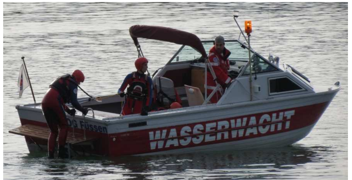
Alu-Boot „Crestliner“ mit 185 PS Innenbordmotor und Duoprop-Z-Antrieb
